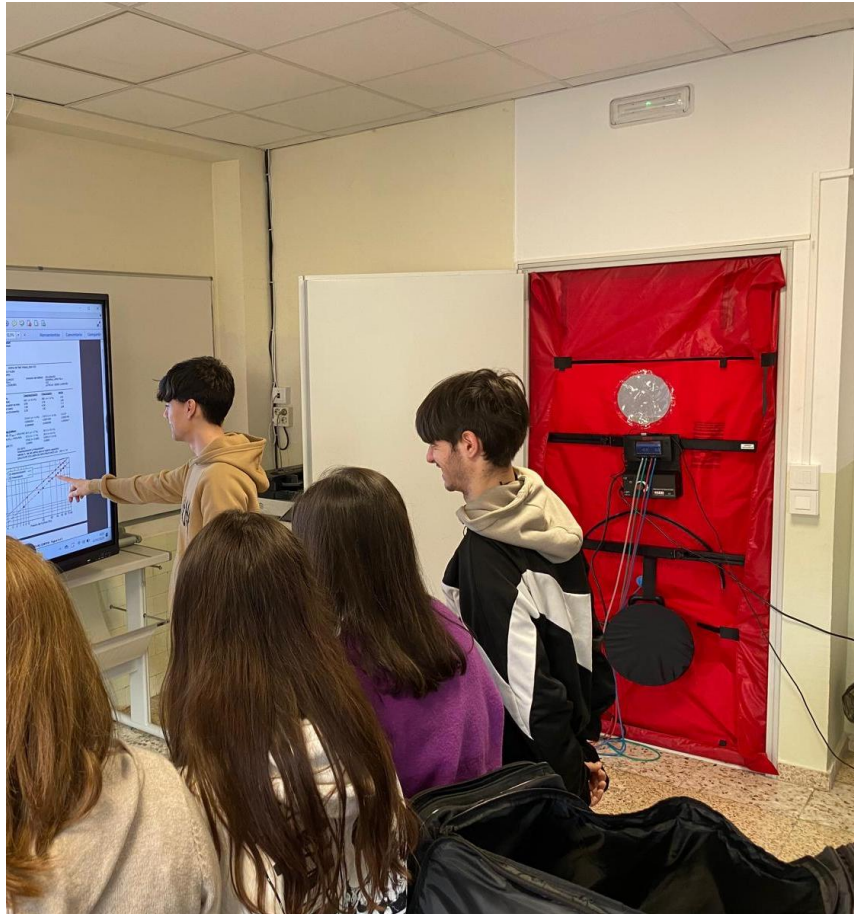
Alumnos realizando prácticas de hermeticidad de envolvente con BlowerDoor
